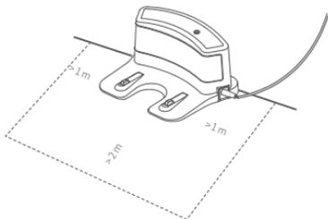
3) Um sicherzustellen, dass der Roboter funktioniert und regelmäßig zur Ladestation zurückkehrt, vermeiden Sie es, die Ladestation zufällig und häufig zu bewegen.
