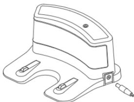
2) Stellen Sie die Ladestation auf einen horizontalen Boden und schließen Sie die Stromversorgung an.
